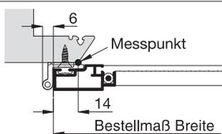
**Bei sehr schrägem Falz anderen Messpunkt verwenden:**
