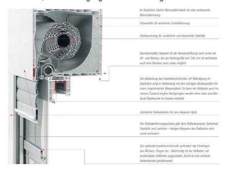
**Bild 7** Integriertes System mit Fenster, Rollladen und Insektenschutz (Bild: Rehau)
