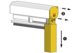
Kastenkappe max. 70 mm herausziehen dabei Kastenprofil und Kastenkappe festhalten. Die Federkraft kann durch Drehen der Kastenkappe im Uhrzeigersinn erhöht (+) oder durch Drehen gegen den Uhrzeigersinn verringert (-) werden.
