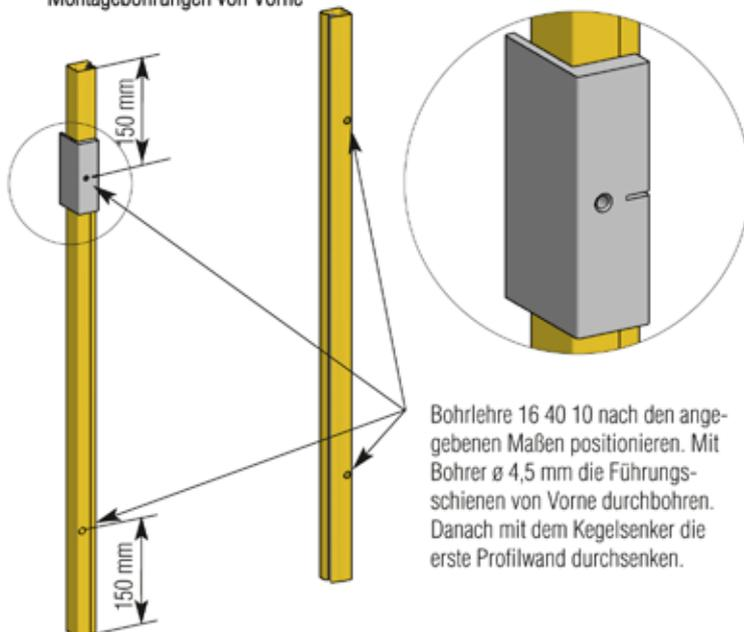
Bohrlehre 16 40 10 nach den angegebenen Maßen positionieren. Mit Bohrer ø 4,5 mm die Führungsschienen von Vorne durchbohren. Danach mit dem Kegelsenker die erste Profilwand durchsenken.
