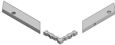
Obere und seitliche Laufschieneprofile mit den Schraubeckwinkeln zu einem U-Rahmen zusammenstecken.
