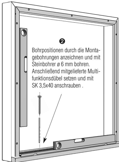
② Bohrpositionen durch die Montagebohrungen anzeichnen und mit Steinbohrer  $\varnothing$  6 mm bohren. Anschließend mitgelieferte Multifunktionsdübel setzen und mit SK 3,5x40 anschrauben.
