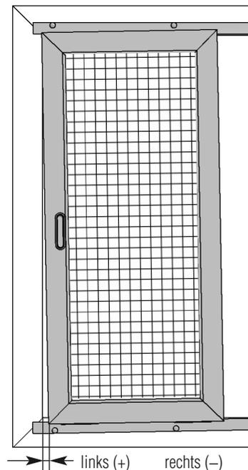
Durch Verschieben des Kunststoffrollenhalters in die ( — ) Richtung, wandert der **Schiebeflügel** auf dieser Seite um **1 mm nach unten**.
