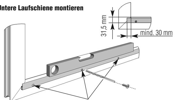
Durch die Montagebohrungen vorbohren und mit RK 3,5x13 anschrauben.
